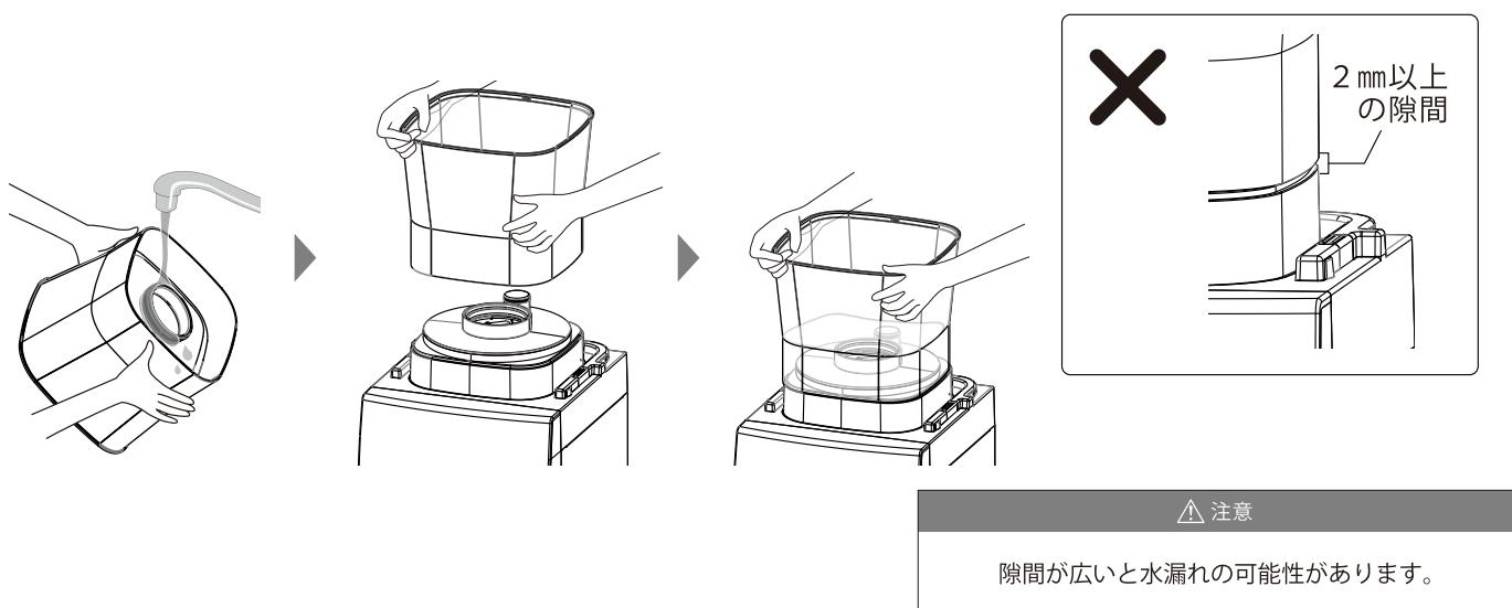
⑤①で浸した浄水カートリッジをセットし、浄水タンク蓋・カバーを付けます。
