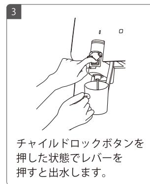
チャイルドロックボタンを押した状態でレバーを押すと出水します。
